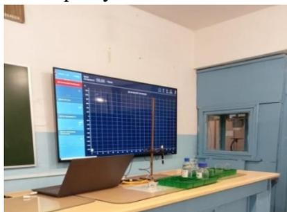
Чтобы показать возможности изучения химических процессов, на уроке химии использовали датчик pH и датчик температуры. Данные выводились на экран в виде графиков, что позволило определить какие параметры меняются в ходе реакции.
